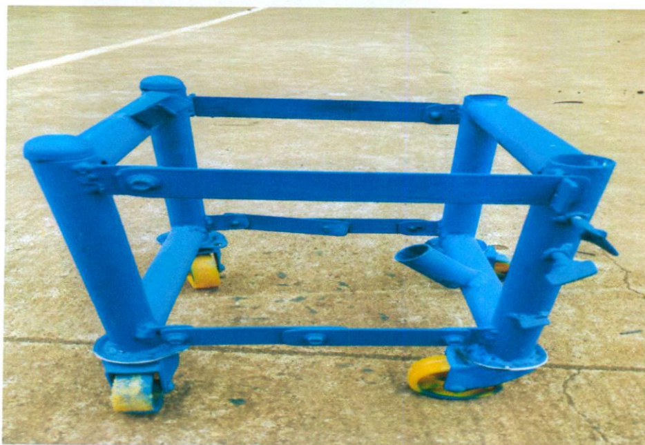
Hình 6. Thanh ngang có ốc vít với tác dụng thu xếp gọn dụng cụ và giữ thẳng bằng mô hình.
