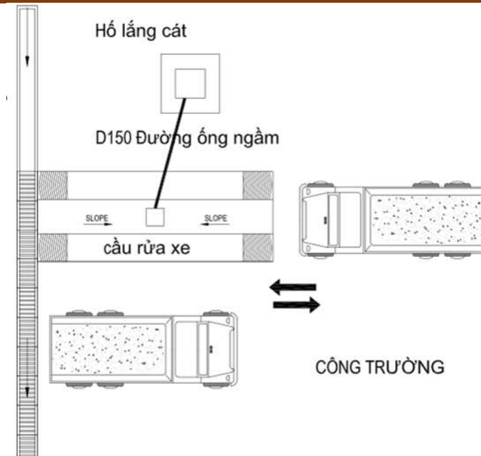
Hình 4.1. Cầu rửa xe ra vào công trường
