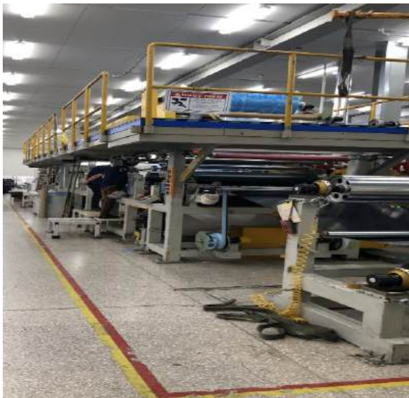
Hình 16. Xưởng sản xuất Carbon, thủy tinh, aramid Pre – preg dạng
