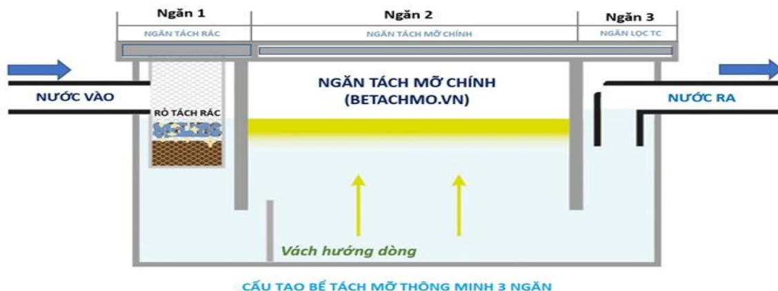
Hình 3.4. Cấu tạo bể tách dầu
