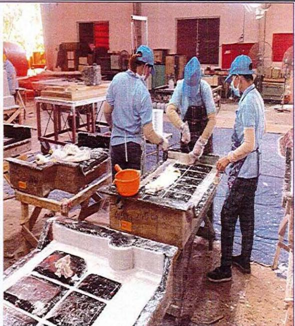
**Bước 1: Phủ chất đánh bóng, gelcoat lên bề mặt khuôn** (Phòng sơn thực hiện quá trình phun gelcoat)
