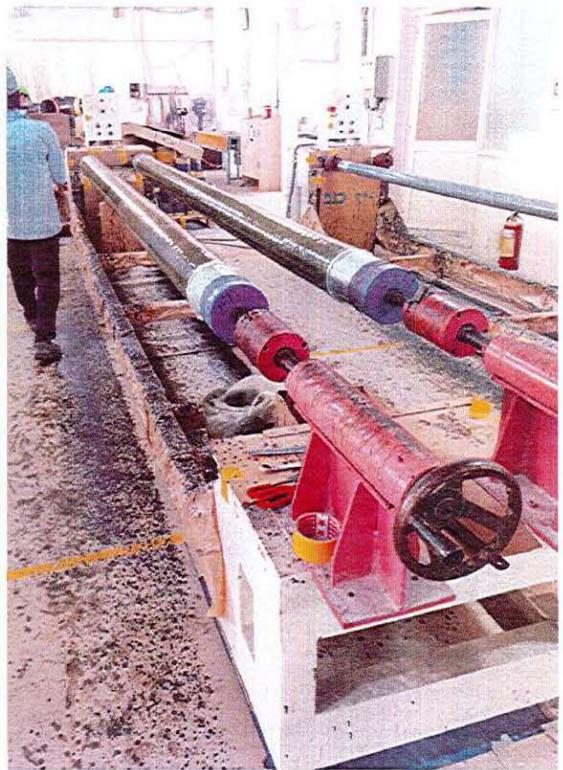
**Bước 2: Tạo hình** bằng máy phun
