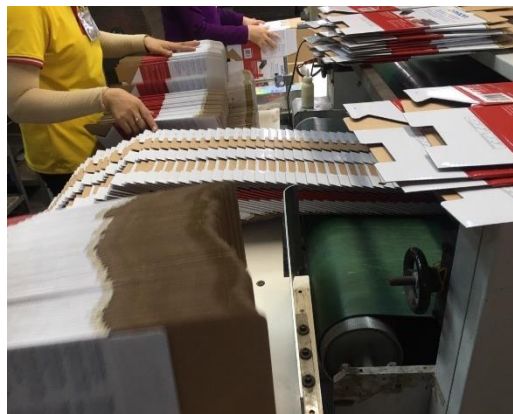
Công đoạn gián hộp tự động
