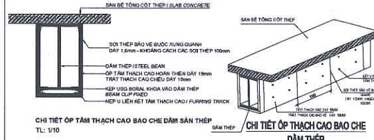
CHI TIẾT ỐP TẤM THẠCH CAO BẢO CHÊ DẪM SÀN THÉP
