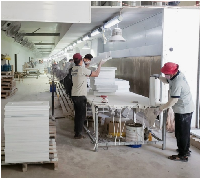
Hình 4.3. Buồng màng nước thu hồi bụi từ quá trình chà nhám thủ công
